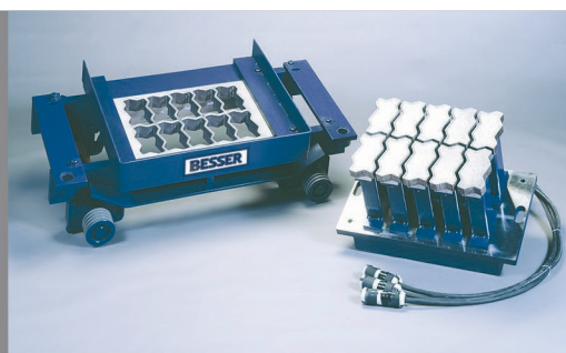
Moule pour pavés avec système de guidage et bas collants.
