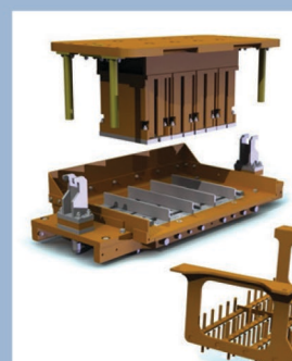
Moule pour pavés avec système de guidage et bas collants.
