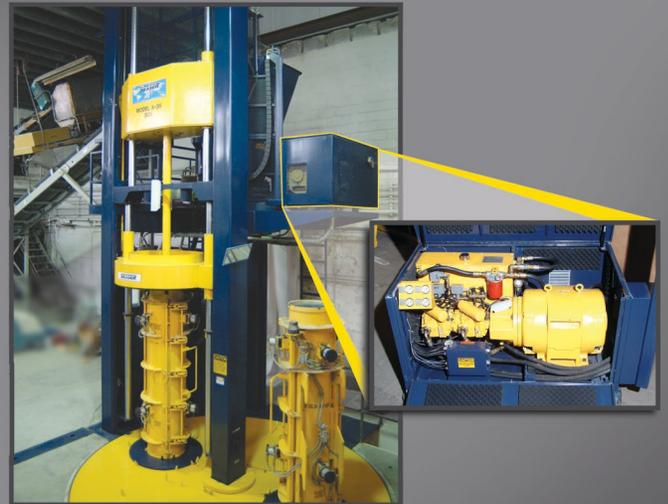
Le groupe moteur de traverse déporté est monté sur le bâti de la machine au niveau du convoyeur, il est facilement accessible depuis la plateforme de travail pour la maintenance et l'entretien périodique. Un capotage assure l'insonorisation du groupe moteur tout en protégeant les composants.
