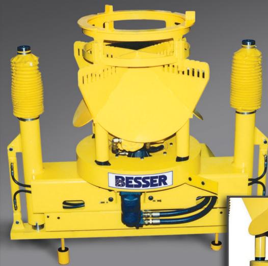
La fonction du vibreur hydraulique à impact vertical donne une compaction efficace du béton dans la cloche. L'utilisation du vibreur aussi réduit le temps du cycle de la cloche et élimine l'anneau collecteur et l'entretien associé.
