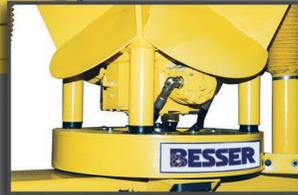
L'ensemble hydraulique de l'empaqueteuse à cloche de centrage peut recevoir des accessoires vibrants/rotatifs support à changement rapide, ce qui permet d'optimiser la qualité et l'efficacité pour la fabrication de tuyaux. Des soufflets protecteurs sur les arbres empêche toute pénétration de débris dans le système de guidage.
