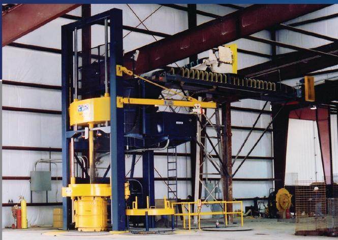
*Vue latérale du modèle Advantage A-60, illustrant la configuration exclusive à trois piliers. Cette conception permet de déverser le matériau dans la trémie soit par l'arrière (comme ici), soit par les côtés.*
