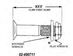
RECOMMENDED FLAT WASHER ORIENTATION AS SHOWN INSTALLATION TORQUE 285-300 FT LBS - TURNING THE NUT
